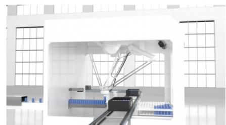
Cámara de eventos industrial utilizada en procesos de producción para analizar fallos y visualizar en tiempo real el interior de la máquina
